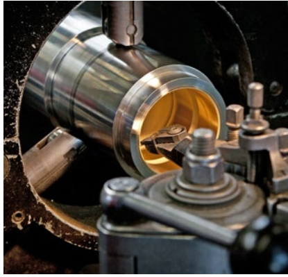
Thermische Spritzschichten, hier eine Bronze-schicht, lassen sich mechanisch bearbeiten.
