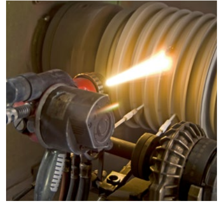
Das Bild zeigt die Beschichtung von Seiltrommeln mit Wolframkarbid.
